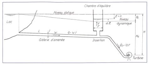
Bild 3. Definitionsskizze zum Wasserschloss (Cuénod und Gardel, 1950).
