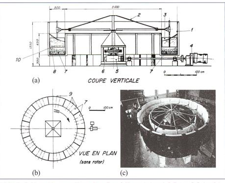
Bild 7. Definitionsskizze vom Versuchsaufbau © Versuchskanal, © Rotor, © Schaufel, Motorenantrieb, © Drossel, © Kupplung, © Sohlenproben, ® Wasser und Sediment, Messachsen, © raue Decke (Gardel und Dysli, 1965).
