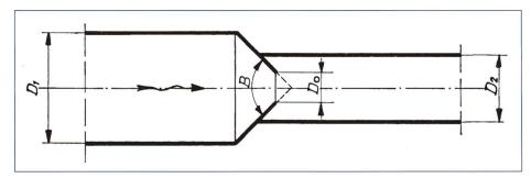
Bild 6. Definitionsskizze vom Versuchsaufbau (Gardel, 1962).
