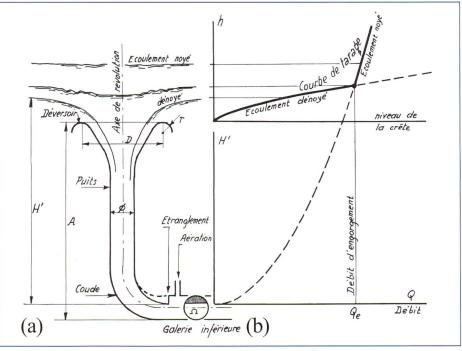
Bild 2. Schachtüberfall (a) Bezeichnungen, (b) Durchfluss-Überfallhöhen-Beziehung (Gardel, 1949).
