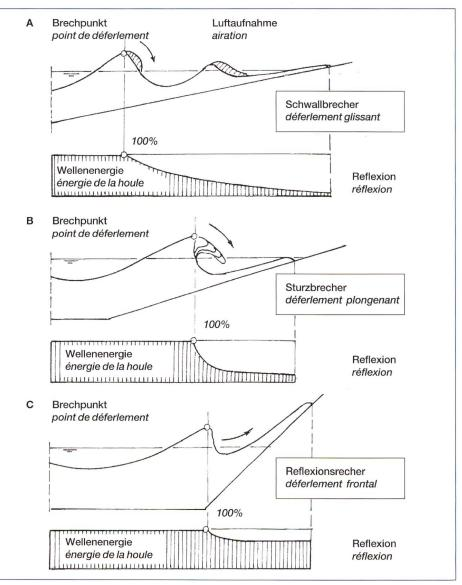
Figure 2. Les types de déferlement et la dissipation d'énergie.
