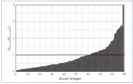
Bild 6. Veränderungsfaktor ( $Q_{B,max,BB}$  /  $Q_{B,max,SB}$ ) des maximalen Breschenabflusses nach BASEbreach ( $Q_{B,max,BB}$ ) im Vergleich zum maximalen Breschenabfluss nach der Standardbresche ( $Q_{B,max,SB}$ ).
