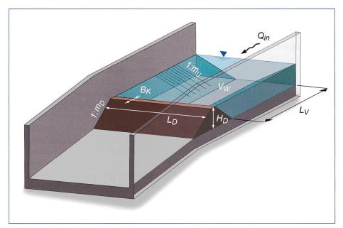
Bild 3. Definition der relevanten geometrischen Einflussgrössen.
