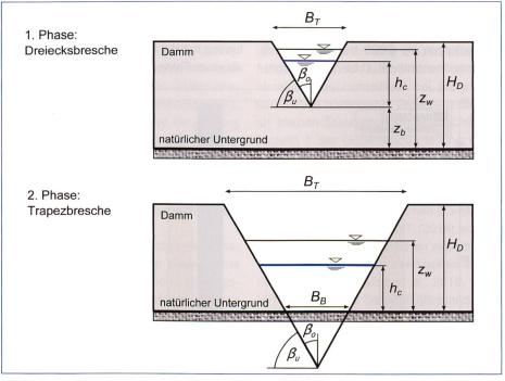
Bild 5. Breschenentwicklung im Parametermodel BASEbreach, adaptiert nach Macchione (2008).
