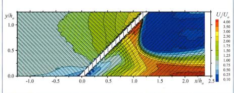
Bild 4. Mittlere, relative Fliesseschwindigkeiten Ober- und Unterstrom eines Louvers mit  $a = 45^{\circ}$ ,  $\beta = 90^{\circ}$  und B = 6 cm.
