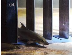
Bild 8. Barben im Versuch mit modifiziertem Bar-Rack ( $a = 15^{\circ}$  und B = 12 cm) und permanentem Kontakt zum Leitrechen bei  $U_0 = 0.6$  m/s (Foto: D. Flügel).
