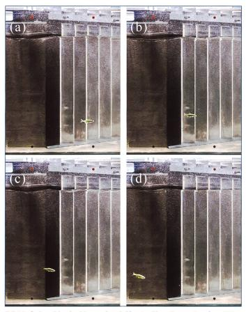
Bild 9. Schneider im Versuch mit Kontrollkonfiguration (a = 30°,  $\beta$  = 30° und B = 6 cm) in zeitlicher Abfolge zwischen Bypass-Annäherung und Bypass-Eintritt (a) bis (d) bei  $U_o$  = 0.6 m/s.
