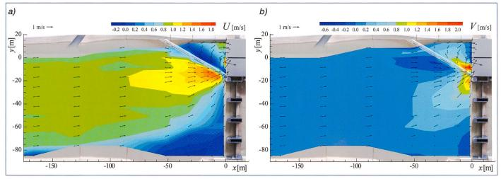
Bild 12. Grossräumige Kraftwerksanströmung mit klassischem Louver (a = 30°), (a) Longitudinalgeschwindigkeit U, (b) Transversalgeschwindigkeit V mit Darstellung der Resultierenden U, als Vektorpfeile.
