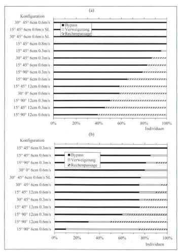
Bild 10. Ergebnisübersicht zur Leiteffizienz der Versuchsreihen mit (a) Barben und (b) Schneidern; Angaben in Legende: a [°],  $\beta$  [°],  $\beta$  [cm],  $U_o$  [m/s],  $\beta$  SL = Sohlleitwand.
