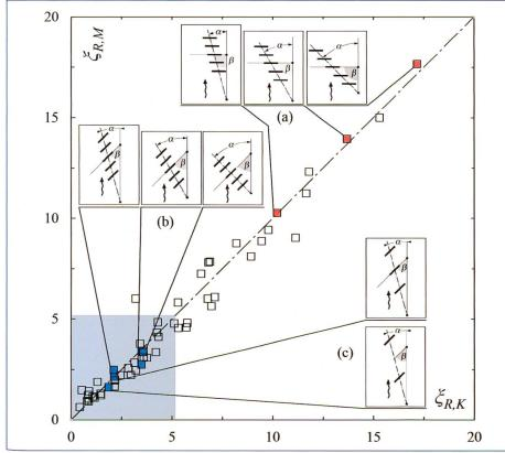
Bild 5. Ergebnisübersicht mit Auswahl wichtiger Leitrechenkonfigurationen: (a) Louver mit a =  $15^\circ$ ,  $30^\circ$ ,  $45^\circ$  bei B = 6 cm ( $\sigma$  = 0.17); (b) modifizierte Bar-Racks analog zu (a); (c) modifizierte Bar-Racks mit a =  $15^\circ$  und B = 12 cm und 24 cm ( $\sigma$  = 0.08 resp. 0.04); die blaue Zone repräsentiert Verlustbeiwerte von Einlaufrechen Schweizer Kraftwerke nach Meusburger (2002).
