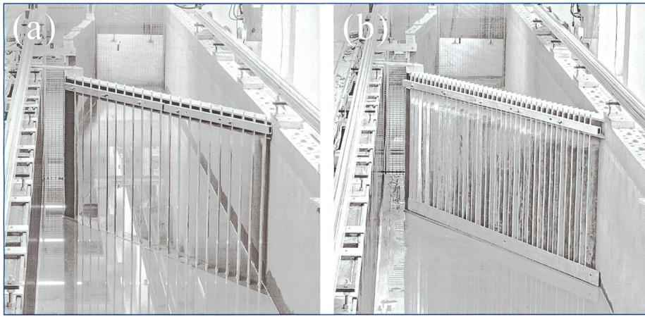
Bild 7. Leitrechen im ethohydraulischen Modell: (a) Kontrollkonfiguration und (b) modifiziertes Bar-Rack mit Sohlleitwand.
