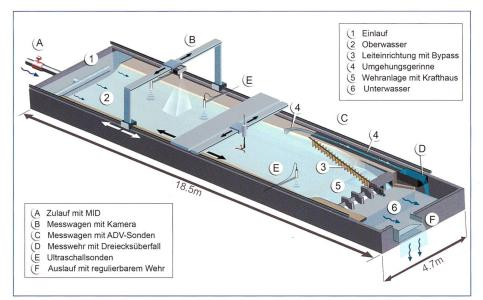
Bild 11. Prinzipskizze des Kraftwerksmodells mit Bezeichnung der wichtigsten Modellkomponenten und Messinstrumente.
