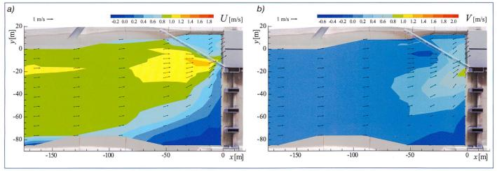
Bild 13. Grossräumige Kraftwerksanströmung mit modifiziertem Bar-Rack ( $a = 30^{\circ}$ ), (a) Longitudinalgeschwindigkeit U, (b) Transversalgeschwindigkeit V mit Darstellung der Resultierenden U<sub>r</sub> als Vektorpfeile.
