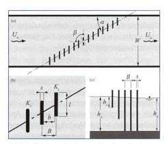
Bild 3. Geometrische und hydraulische Parameter der Leitrechenversuche.
