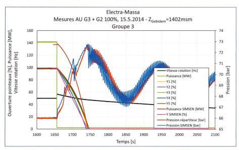
Figure 6. Comparaison entre simulation et mesures sur site du comportement transitoire du groupe 3 en cas d'arrêt d'urgence simultané des groupes 2 et 3 à une puissance totale de 240 MW.
