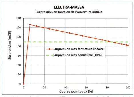
Figure 9. Surpression due au coup de Bélier survenant en cas d'arrêt d'urgence des 3 groupes en fonction de la course initiale des pointeaux avant l'arrêt d'urgence.
