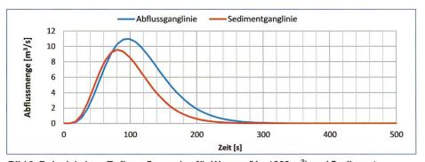
Bild 8. Beispiel eines Zufluss-Szenarios für Wasser ( $V = 1009 \text{ m}^3$ ) und Sediment ( $V_S = 878 \text{ m}^3$ ).
