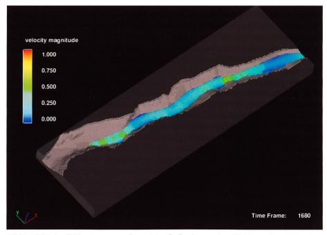
Bild 11. Bild des Trübestroms am Grund des Gallo-Arms, eingefärbt mit der mittleren Fliessgeschwindigkeit.
