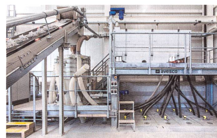
Bild 5. Vollautomatisierte Siebanlage mit Beschickung, Taumelsieb, Förderschnecke und Mehrdecksieb; die Siebanlage trennt die Sand- und Kiesfraktionen direkt in die Fraktionssilos.
