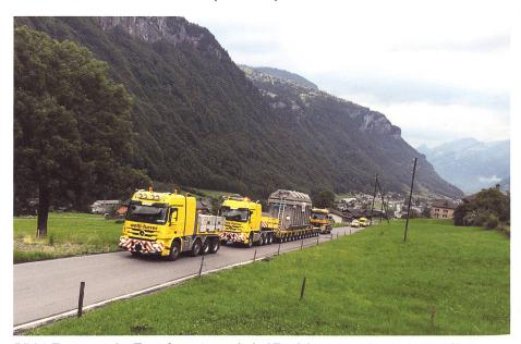
Bild 4. Transport des Transformators mit drei Zugfahrzeugen durchs Linthal (Foto: ABB).
