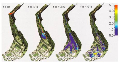
Bild 6. Fliesstiefe für den Momentanbruch der Sperre Brand bei Füllung bis Stauziel zu verschiedenen Zeitpunkten.
