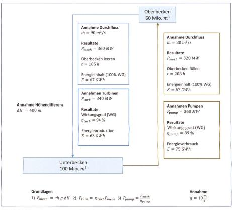
Bild 2. Zyklus eines Pumpspeicherkraftwerkes. Eigene Darstellung.
