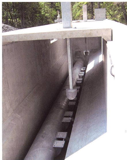
Bild 6. Moderne, kostengünstige Sedimentmesseinrichtung.
