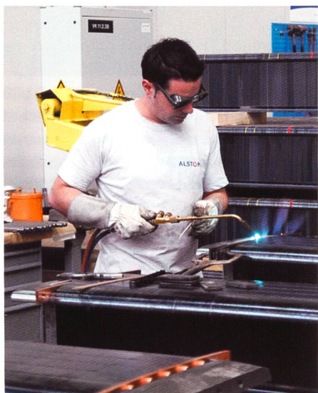
Bild 2. Polfertigung im Polworkshop in der ALSTOM Fabrik in Birr, Kanton Aargau.
