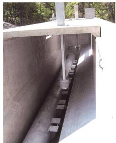
Bild 6. Moderne, kostengünstige Sedimentmesseinrichtung.
