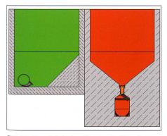
Bild 3. Vergleich des Querschnitts eines konventionellen Entsanderbeckens mit den Möglichkeiten bei Einbau des HSR-Abzugsystems: Einsparungen im Aushub oder Ausbruch und wesentlich höhere Lage des Spülrohres. Damit werden auch Spülleitungen in sehr flachem Gelände erst möglich.
