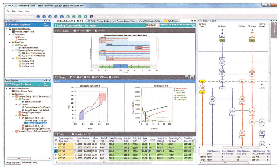
Bild 1. Benutzeroberfläche der Engineering-Software PinCH 2.0, mit welcher der Energieeinsatz von industriellen Prozessen optimiert werden kann.
