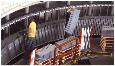
Bild 3. Schichten des Blechpakets nach ALSTOM-Design.
