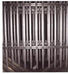
Bild 7. Bezüglich Zuverlässigkeit, Instandtandhaltung und Sicherheit optimierte, rostfreie Konstruktion eines Beruhigungsrechens.
