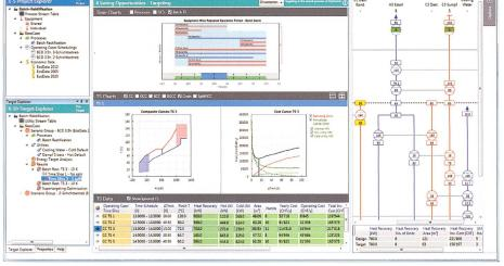
Bild 1. Benutzeroberfläche der Engineering-Software PinCH 2.0, mit welcher der Energieeinsatz von industriellen Prozessen optimiert werden kann.
