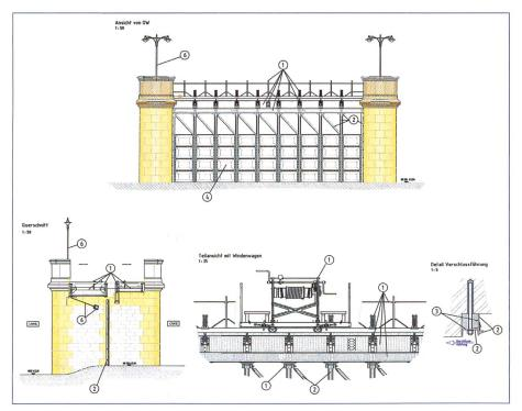
Bild 5. Beschichtungssysteme für Stahlwasserbauteile des Pretziener Wehrs.
