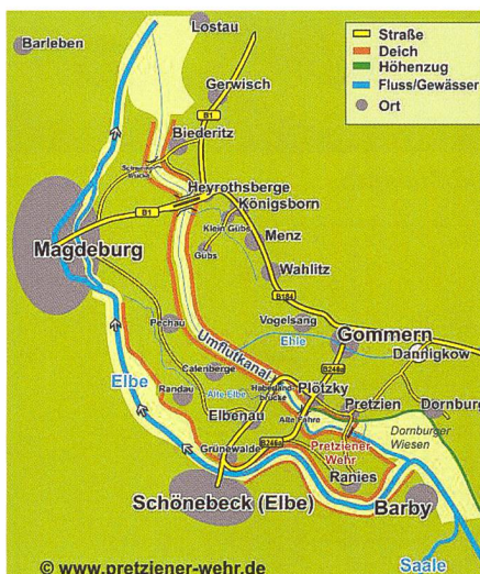
Bild 1. Anordnung des Pretziener Wehrs an der Elbe mit Umflutkanal und dem Leitpegel Barby.
