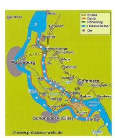
Bild 2. Das bei Hochwasser geöffnete Pretziener Wehr – mit Umleitung eines Teils des Elbwassers durch den Umflutkanal – an Schönebeck und Magdeburg vorbei.
