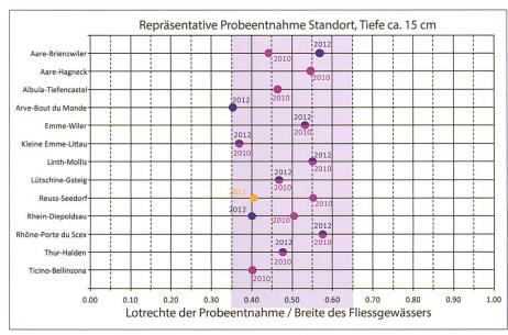
Bild 12. Die für die SSC repräsentativen Stichproben, in einer Tiefe von rund 15–20 cm entnommen, sind im Bereich der Flussmitte angesiedelt. Die Stichproben werden in dieser Tiefe entnommen, um die potenziellen Gefahren einer Entnahme bei Hochwasser zu reduzieren.
