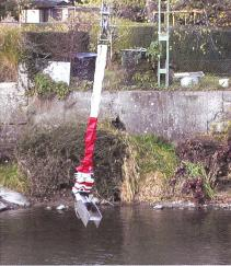
Bild 7. Zweimal wöchentlich durchgeführte Probeentnahme von einer Brücke aus (links) oder mit einer Seilkrananlage einer hydrometrischen Station (rechts).
