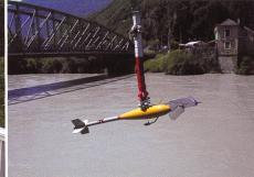
Bild 8. Die Aufnahme der Schwebstoffkonzentrationsprofile erfolgt von einer Brücke aus (links) oder mit einer Seilkrananlage bei einer hydrometrischen Station (rechts).
