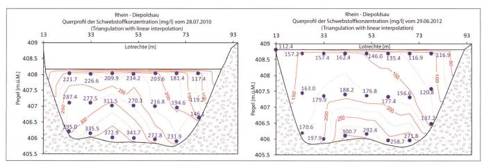
Bild 4. SSC-Profile vom 28.7.2010 und vom 29.6.2012 bei der Messstation Rhein-Diepoldsau. Die Konzentrationen nehmen mit der Wassertiefe zu und gehen an den Rändern des Flussbetts zurück.
