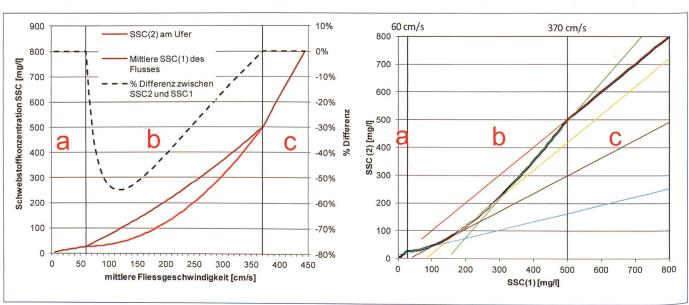
Bild 11.(Linkes Bild) Mathematische Simulation, gemäss dem Model von (Edward und Glysson 1999), des Verlaufes der SSC in Funktion der Zunahme der Fliessgeschwindigkeit. (Rechtes Bild) Die Simulation zeigt, dass man die Fliessgeschwindigkeit berücksichtigen sollte, um eine lineare Korrelation (siehe die verschiedenen farbigen Geraden) zwischen der SSC1 und SSC2 erstellen zu können.
