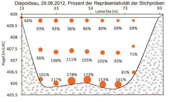
Bild 9. Mit Schwebstoffkonzentrationsprofilen lässt sich die Vertikale für die bezüglich der SSC repräsentativen Probeentnahmen definieren.
