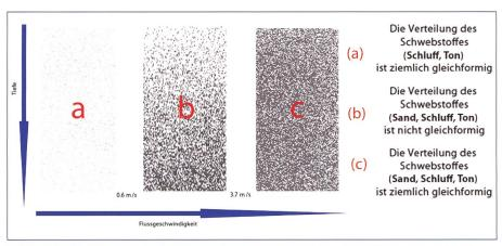
Bild 2. Die Fliessgeschwindigkeit bestimmt weitgehend die Verteilung der SSC in der Wassersäule (Edward und Glysson 1999).
