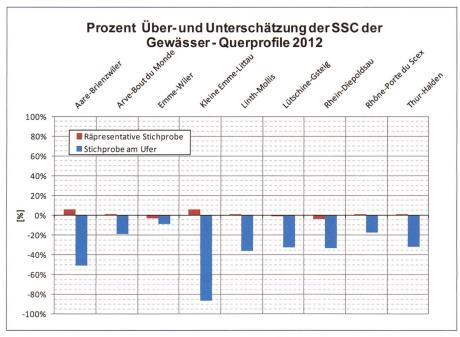
Bild 10. Am Ufer des Fliessgewässers entnommene Stichproben ergeben viel zu niedrige SSC-Schätzwerte. Die Berechnung der mittleren Schwebstoffkonzentration erfolgt aus 21 Messpunkten des SSC-Profils.
