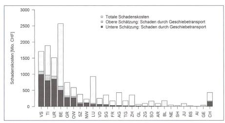
Bild 2. Verteilung der Schadenskosten nach Kantonen für die Periode von 1972 bis 2011: Totale Schadenskosten der Unwetterschadens-Datenbank WSL, untere und obere Schätzung der Schadenskosten durch Geschiebeprozesse. Rund 430 Mio. CHF der totalen Schadenskosten konnten nicht einem einzelnen Kanton zugeordnet werden (Abkürzung CH).
