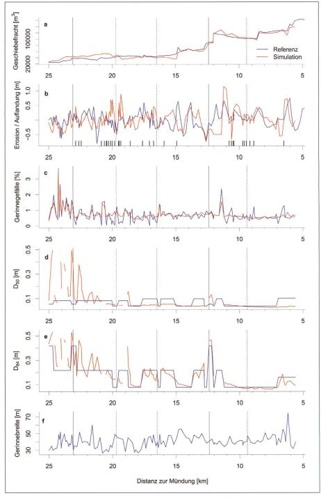
Bild 6. Kleine Emme, Simulationsresultate der Best-Variante (mit Formeln 1a, 2a, 3b,c, 3d mit  $\theta_{c50,min}$  = 0.06) für die Kalibrierungsperiode von 2000 bis 2005. Dargestellt sind die akkumulierte Geschiebefracht, die Sohlenveränderung bzw. die Erosion und Auflandung, das Gerinnegefälle, die charakteristischen Korngrössen  $D_{50}$  und  $D_{84}$  sowie die Gerinnebreite entlang der Untersuchungsstrecke.
