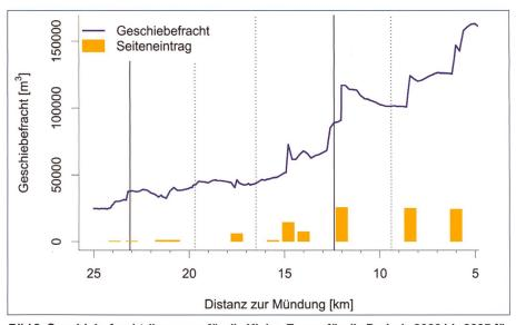
Bild 3. Geschiebefrachtdiagramm für die Kleine Emme für die Periode 2000 bis 2005 für die Untersuchungsstrecke von Doppleschwand bis Littau. Die in Orange markierten Balken geben die während des Hochwassers 2005 als Seitenerosion eingetragenen Geschiebefrachten (ohne Feinmaterial) in den Hauptfluss an.
