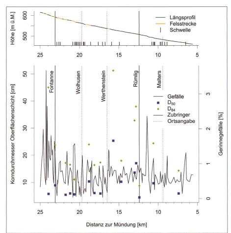
Bild 2. Kornverteilungen in der Kleinen Emme, gemäss Linienproben der WSL und von Burkhard (2012). Dargestellt sind die charakteristischen Korndurchmesser  $D_{50}$  und  $D_{84}$  der Deckschicht entlang der Untersuchungsstrecke (wobei jeweils 50% respektive 84% des Gewichtsanteils des Sohlenmaterials feiner sind).
