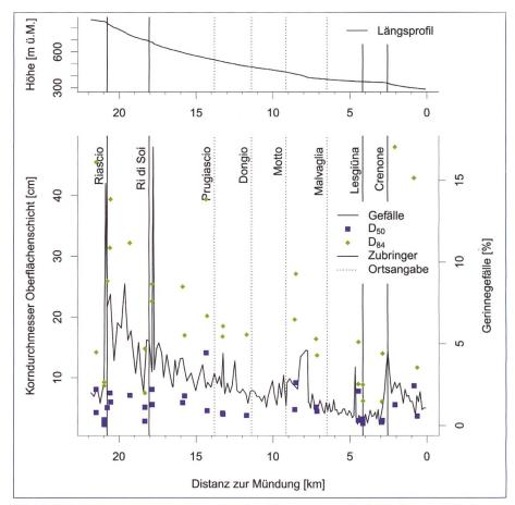
Bild 4. Kornverteilungen im Brenno, gemäss Linienproben der WSL. Dargestellt sind die charakteristischen Korndurchmesser  $D_{50}$  und  $D_{84}$  der Deckschicht entlang der Untersuchungsstrecke (wobei jeweils 50% respektive 84% des Gewichtsanteils des Sohlenmaterials feiner sind).
