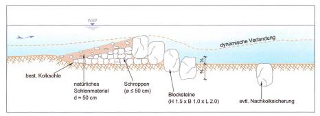
Bild 9. Lenkbuhnenaufbau bei Einbau in Kurvenkolk (Schnitt in Fliessrichtung).
