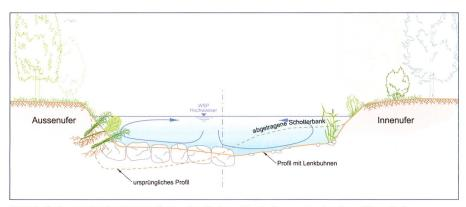
Bild 6. Schematische Darstellung der Sekundärströmungen in einer Flusskrümmung mit inklinanten Lenkbuhnen bei Hochwasserabfluss (nach Grober 1998, modifiziert).
