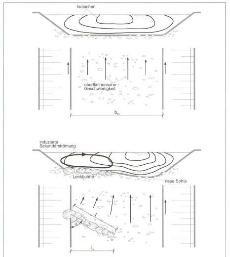
Bild 4. Schematische Isotachendarstellung einer geraden Gewässerstrecke ohne (links) und mit inklinanter Lenkbuhne (rechts; Sindelar & Mende 2009, modifiziert).
