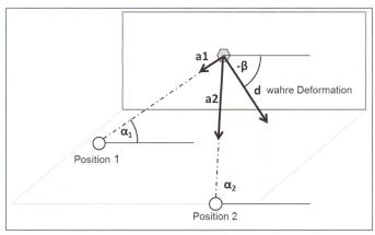
Bild 1. Messprinzip einer Deformationsmessung in 2D auf ein Ziel, welches sich in Richtung d bewegt. Von den zwei Positionen  $P_1$  und  $P_2$  aus werden die Deformationskomponenten  $a_1$  und  $a_2$  gemessen.
