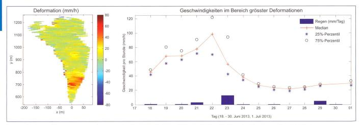
Bild 10. Deformationsmessungen im Bereich schneller Deformationen am Kegelhals an der Rutschung im Val Parghera. Links: Örtlich aufgelöste Deformationen (Rot bedeutet eine Annäherung ans Radar). Rechts: Variation der Geschwindigkeiten im unteren Rutschbereich während der Messkampagne sowie Messdaten der benachbarten Regenmessstation.
