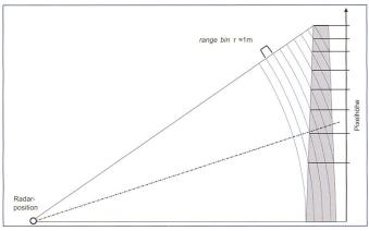
Bild 2. Vertikale Pixelgrösse in Abhängigkeit der Radarposition vor einer Talsperre.
