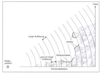
Bild 3. Schematische Darstellung von Radarschatten und Overlay im Kontext der Radar-Aufnahmegeometrie.
