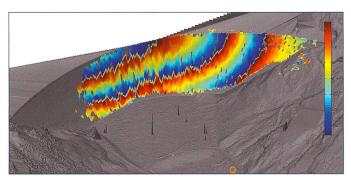
Bild 4. Phasendifferenz von zwei Messkampagnen mit einem um 10 m veränderten Seepegel. Der Radarstandort ist mit einem orangen Kreis markiert. Ein Farbzyklus von Blau nach Rot bedeutet eine Verschiebung um eine volle Phase, was einer Oberflächendeformation um eine halbe Wellenlänge entspricht.
