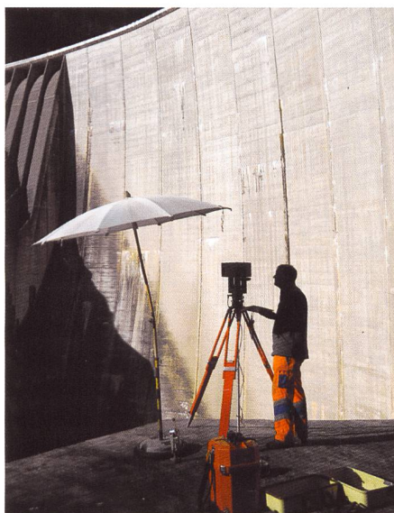
Bild 4. Präzise Distanzmessung bei der Stauanlage Contra.
