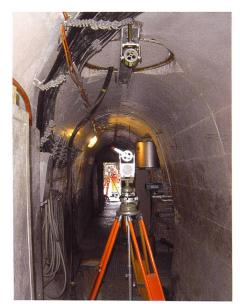
Bild 2. Einmessung eines Lotdrahtes.
