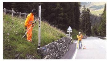
Bild 9. Nivellement im Rutschhang Natons, Stauanlage Marmorera.
