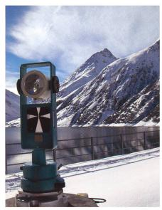
Bild 6. Präzisionsreflektor.
