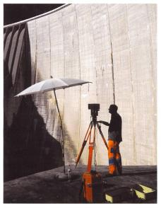
Bild 4. Präzise Distanzmessung bei der Stauanlage Contra.
