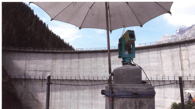
Bild 8. Einsatz des Kern-Mekometers ME5000 bei der Stau-mauer Sufers.
