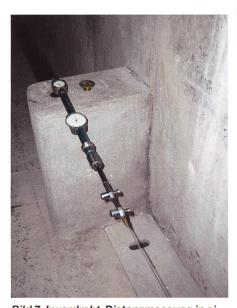
Bild 7. Invardraht-Distanzmessung in einem Kontrollgang der Staumauer Contra.
