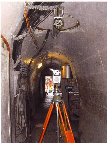
Bild 2. Einmessung eines Lotdrahtes.
