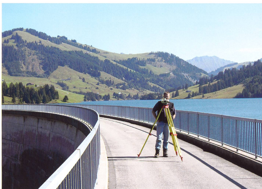
Bild 1. Präzisionsnivellement über die Mauerkrone der Stauanlage Hongrin.
