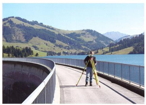
Bild 1. Präzisionsnivellement über die Mauerkrone der Stauanlage Hongrin.
