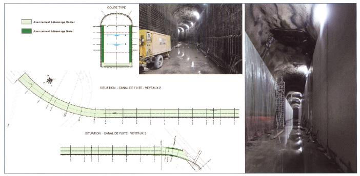
Figure 10. Schéma du canal de fuite.
