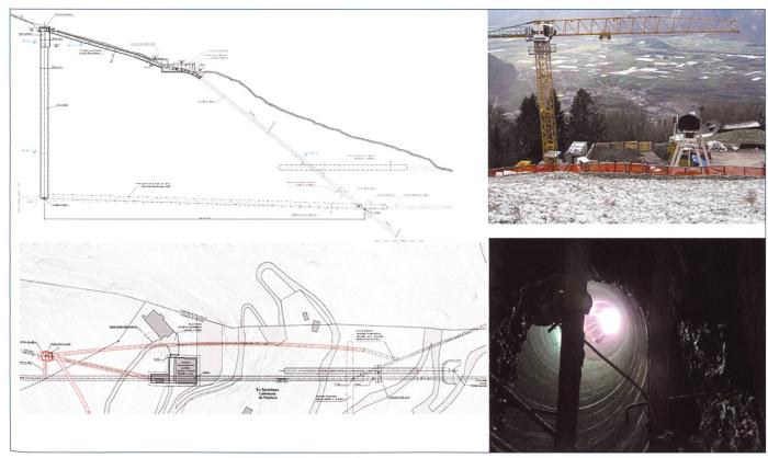
Figure 7. Schéma des cheminées d'équilibre existante et nouvelle.
