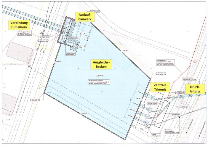
Bild 4. Situation Zentrale und Ausgleichsbecken Trimmis.
