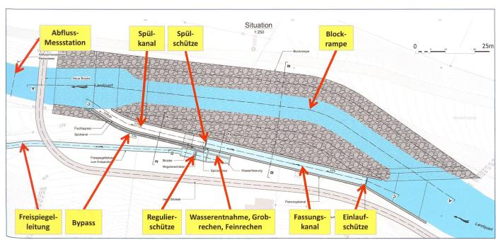
Bild 5. Situation der Blockrampenfassung Küblis.
