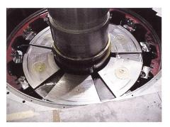
Bild 2. Druckölentlastung für Traglager.
