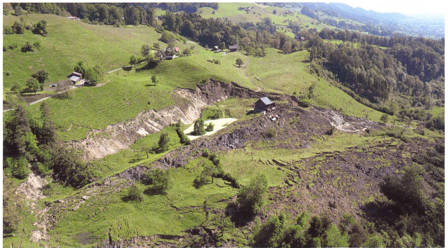
Bild 8. Am 4. Juni rutschten im Gebiet Ober Weidist in Altstätten SG rund 1 Mio. m 3 Erdmasse talwärts. Ein Stall wurde beschädigt und tiefe Risse zeigten sich in der Weide (Foto: Tiefbauamt Kanton SG).
