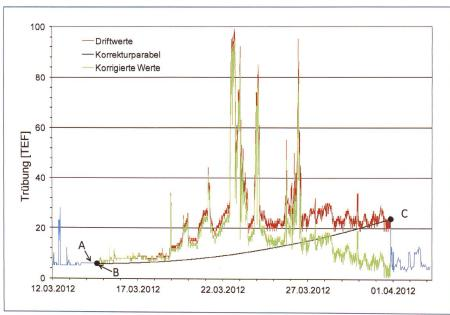
Bild 4. Parabolische Korrektur der gerätebedingten Driftwerte bei Trübungsmessungen.
