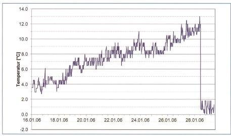
Bild 1. Beispiele für Driften bei Messungen der Temperatur.
