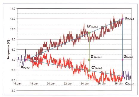
Bild 3. Beispiel einer linearen Korrektur der Temperatur.
