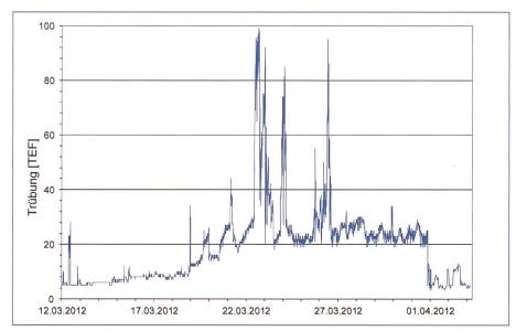
Bild 2. Beispiele für Driften bei Messungen der Trübung.
