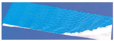
Bild 16. Ansicht von oben. Gut zu erkennen ist, wie die Wellen abgelenkt werden (Refraktion) und ans Ufer branden.
