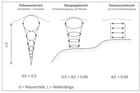
Bild 6. Mögliche Bewegungen der Wasserteilchen in einer Welle.
