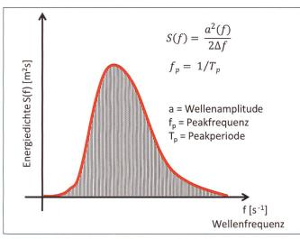
Bild 9. Energiedichtespektrum eines Seeganges.
