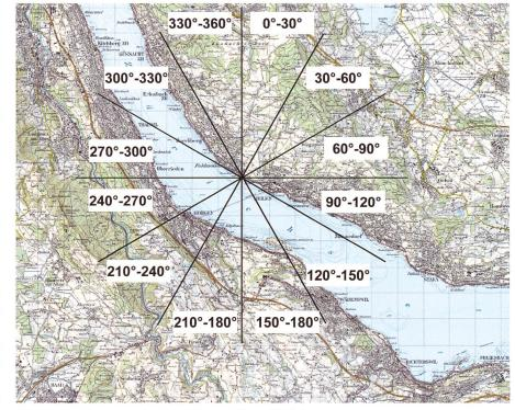
Bild 11. Bestimmung der Fetchlängen für zwölf Sektoren.
