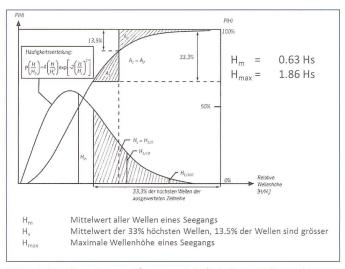
Bild 10. Häufigkeits- und Summenhäufigkeitsverteilung der Wellenhöhen eines Seeganges [6].
