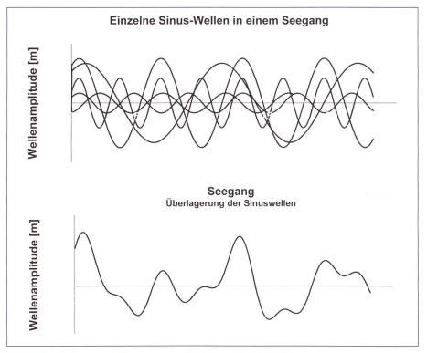
Bild 8. Durch Superposition mehrerer Wellen entsteht der Seegang.
