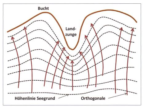
Bild 12. Beispiel von Refraktion, einer der möglichen Flachwasserprozesse.
