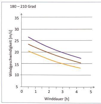
Bild 3. Beispiel eines IDF-Diagramms (Intensität, Dauer, Frequenz) für die Windrichtung 180–210 Grad (orange = 30-jährlicher, braun = 100-jährlicher, violett = 300-jährlicher Wind).
