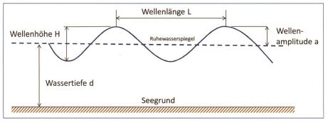
Bild 5. Schematische Wellendarstellung mit Parameter.
