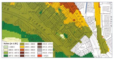
Bild 4. Abgeglichene und ergänzte Wasserspiegellagenkarte HQ<sub>100</sub>-
