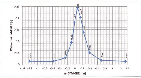
Bild 6. Wahrscheinlichkeitsdiagramm zur Abweichung des auf  $3 \times 3$  m² gerasterten DTM zu Angaben von Schachtdeckelkoten der ERZ [03]. Mit der Wahrscheinlichkeit P = 80% liegt die Abweichung zwischen -0.10 m und +0.30 m, mit einem Häufigkeitsschwerpunkt (Modalwert) bei +0.07 m mit P = 25%.
