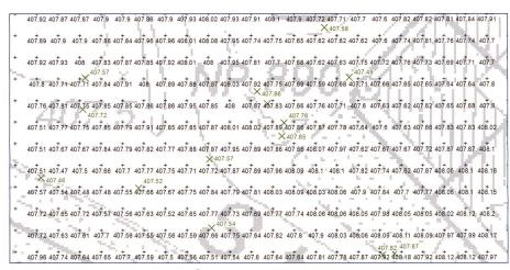
Bild 5. Ausschnitt des auf  $3 \times 3$  m<sup>2</sup> gerasterten DTM (schwarz,  $\leftrightarrow$ ) und Schachtdeckelkoten (grün,  $\leftrightarrow$ ). Bereich Einmündung Dufourstr./ Bellerivestr. (vgl. Bilder 1–4). Der Ausschnitt entspricht ( $70 \times 35$ ) m<sup>2</sup>.
