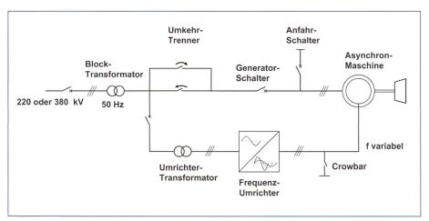
Bild 1. Doppeltgespeiste Asynchronmaschine mit Umrichter im Rotorkreis.
