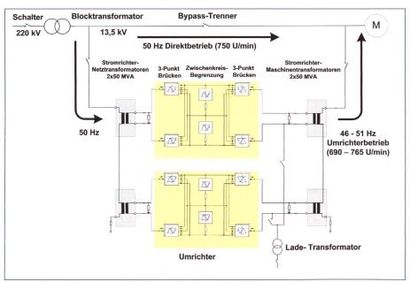
Bild 3. Umrichter mit einer Leistung von 100 MW im Pumpspeicherwerk Grimsel 2. Der Ladetransformator dient der sanften Aufmagnetisierung des Blocktransformators.
