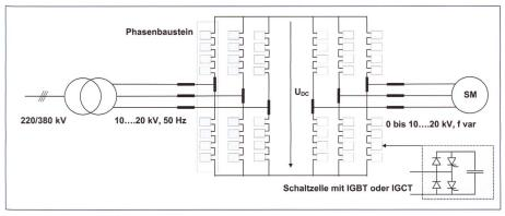
Bild 5. Modular-Multilevel-Converter.
