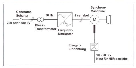
Bild 2. Synchronmaschine mit Vollumrichter.
