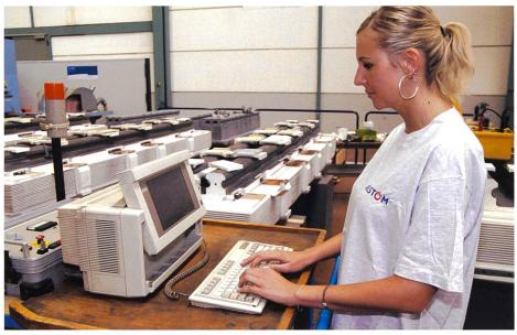
Bild 2. Elektrische Abnahmeprüfungen an Polen im Werk Birr.
