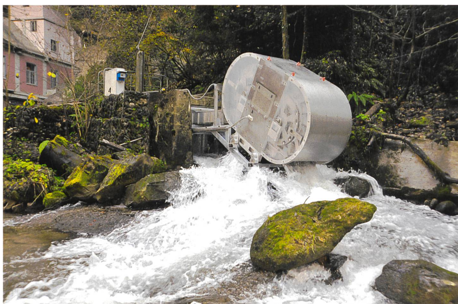
Bild 1. Die Steffturbine ist eine Kleinturbine für die Nutzung von Wasserkraft in klein-räumigem Gelände. Im Bild der Prototyp beim Kleinwasserkraftwerk Pilgersteg in Rüti (Zürich).
