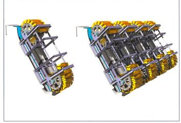
Bild 3. Die Steffturbine ist modular konzipiert. Für das Erreichen einer höheren Gesamtleistung können mehrere Turbinen im Parallelbetrieb eingesetzt werden.
