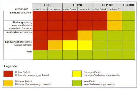
Bild 5. Defizitmatrix am Beispiel Hochwasserschutz.
