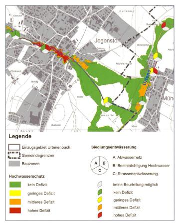
Bild 6. Ausschnitt aus dem Defizitplan Hochwasserschutz und Siedlungsentwässerung.
