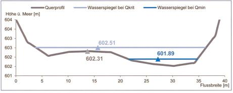
Bild 5. Querprofil der Hasliaare in der Kiesbankstrecke. Links vom grauen Dreieck befindet sich eine potenzielle Fischfalle. Der höchste Punkt der Fischfalle liegt bei 602.31 m ü.M. (graues Dreieck), 20 cm oberhalb davon (bei 602.51 m ü.M., hellblaues Dreieck) beträgt der Abfluss  $Q_{krit} = 8.1 \text{ m}^3/\text{s}$ . Der Wasserstand beim minimalen Abfluss  $Q_{min} = 3.1 \text{ m}^3/\text{s}$  (95%-Perzentil; Tabelle 3) liegt bei 601.89 m ü.M. (dunkelblaues Dreieck).
