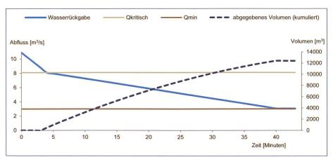
Bild 7. Schematische Darstellung der sanften Reduktion des Beckenausflusses (mit einer Sunkrate von –0.14  $\rm m^3 s^{-1} min^{-1}$ ) und der dabei kumulierten abgegebenen Wassermenge.  $\rm Q_{min}$  = minimaler Abfluss mit 3.1  $\rm m^3/s$  (95%-Perzentil),  $\rm Q_{kritisch}$  = 8.1  $\rm m^3/s$ .
