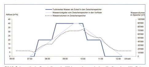
Bild 3. Schematische Darstellung der Wirkung eines zwischen Kraftwerk und Vorfluter geschalteten Ausgleichspeichers.
