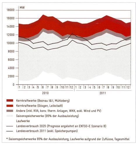
Bild 2. Verfügbare Leistung und Landesverbrauch in der Schweiz im Jahresverlauf 2010 und 2011 (jeweils am 3. Mittwoch des Monats)\*. Die Schweiz verfügt mittelfristig über ausreichende (Reserve-)Kapazitäten bei der Stromproduktion. Eine frühzeitige Ausserbertiebnahme der jüngeren Kernkraftwerke könnte hingegen zu kritischen Versorgungssituatiuonen in den Wintermonaten führen. Quelle: Avenir Suisse auf Basis Elektrizitätsstatistik BFE, Grafik: Avenir Suisse.
