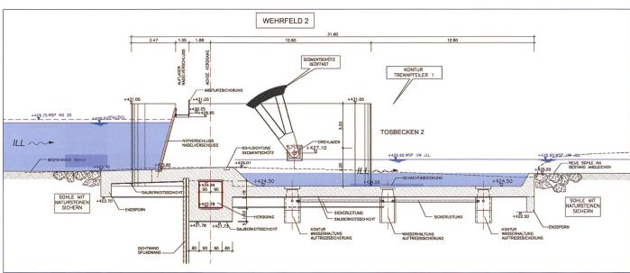
Bild 5. Schnitt durch Wehrfelder 2+3 mit aufklappbaren Wehrsegmenten.
