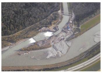
Bild 6. Luftbild während Bau der Wehrfelder, unmittelbar nach dem Oktober-Hochwasser, Nov. 2012.
