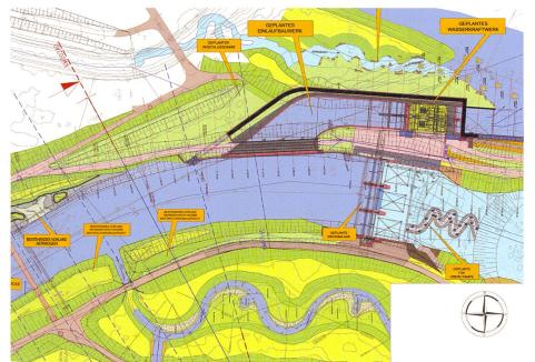
Bild 3. Lageplan Kraftwerk Illspitz mit Wehranlage, Einlaufbauwerk und Maschinenhaus.
