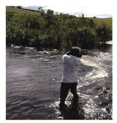
Bild 5. Einspeisung von Salz zur Abflussbestimmung im oberen Teil des Projektgebietes.
