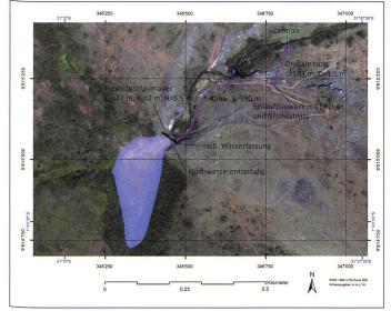
Bild 8. Übersichtsplan des geplanten Kleinwasserkraftwerkes im Gebiet Kitogota unter Verwendung der vorhandenen Bauund Anlagenteile.
