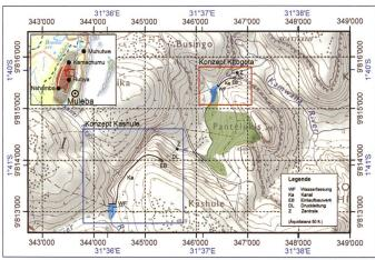
Bild 6. Projektgebiet mit den beiden optimierten Kleinwasserkraftwerks-Konzepten.
