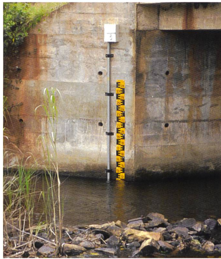
Bild 3. Neu errichtete Abflussmessstation am Fluss Kamwana.
