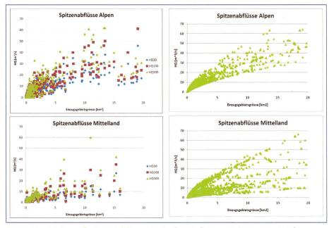
Bild 5. Vergleich von Spitzenabflüssen. Linke Spalte Spitzenabflüsse aus den Gefahrenkarten (Stalder S., 2010), rechte Spalte Spitzenabflüsse für Schwachstellen der GHK Überflutung.
