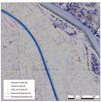
Bild 3. Zur Neuberechnung des DTM werden die relevanten Punkte des DTM-AV (violett) und die Daten, die aus den DTM-Korrekturen stammen, miteinander kombiniert (Hintergrund: Hillshade des aufbereiteten DTM-AV, Kanton Bern).
