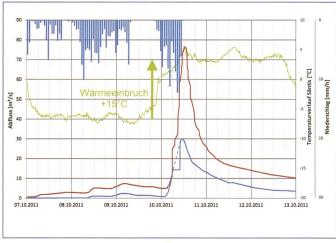
Bild 10. Ereignis Oktober 2011: Überlagerung der Niederschläge und Abflussganglinien Chlostobel (blau), Iltishag (rot) mit dem Temperaturverlauf des Säntis (grün).
