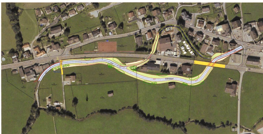
Bild 6. Umlegung der Sântisthur im Gebiet Sändli (Massnahme M2).
