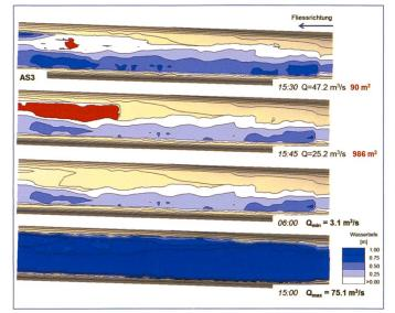
Bild 3. Lage einer potenziellen Fischfalle in der Kiesbankstrecke (rot eingefärbt).
