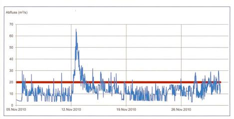
Bild 5. Typische Abflussganglinie der Aare in der Kiesbankstrecke für November 2010. In diesem Flussabschnitt treten günstige Laichbedingungen bei Abflüssen < 20 m³/s (rote Linie) auf.
