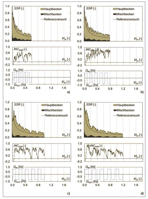
Bild 11. Normierter Sedimentanteil in Suspension SSR, relative Effizienz INC<sub>SSR</sub> und Abfluss Q in Funktion der normierten Zeit  $t/t_m$  für  $C_0 = 0.8$  g/l, Q = 1.1 l/s und  $Kt_p = 0.6$  (a), 0.8 (b), 1.0 (c) und 1.2 (d).
