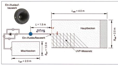
Bild 8. Schema mit Hauptelementen der Versuchsanlage.
