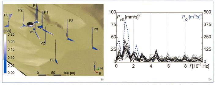
Bild 4. Geschwindigkeitsprofile im numerischen Modell nach 150 Minuten Turbinierbetrieb bei Maximalabfluss (a) und Powerspektren der Zeitreihen von Abfluss ( $P_Q$ ) und Geschwindigkeit ( $P_{VE}$  Ostkomponente) für das Messinstrument P1 im September 2008 (b).
