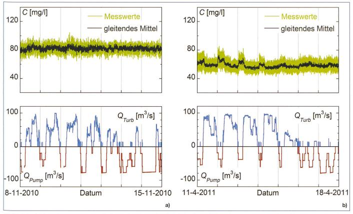
Bild 6. Entwicklung der gemessenen Sedimentkonzentration C und Betriebsabflüsse Q<sub>Pump</sub>, <sub>Turb</sub> während den Messperioden vom 8. bis 15.11.2010 (a, Seepegel Oberaar 2298 m ü. M., Grimsel 1900 m ü. M.) und vom 11. bis 18.4.2011 (b, Seepegel Oberaar 2265 m ü. M., Grimsel 1870 m ü. M.).
