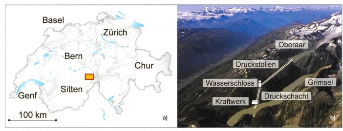
Bild 1. Lage (a) und Hauptelemente (b) des Pumpspeicherwerks Grimsel 2.
