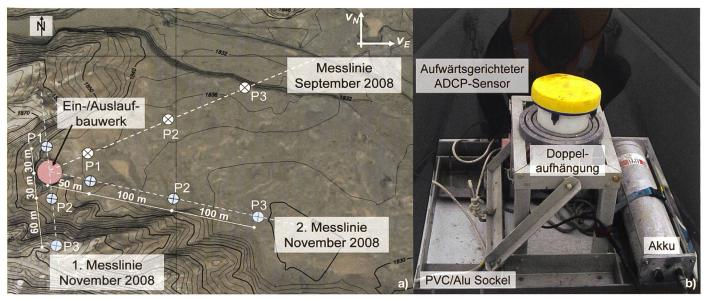
Bild 2. Seetopographie und Messlinien für Geschwindigkeitsprofile im Bereich der Fassung Grimsel 2 (a), Acoustic Doppler Current Profilers (ADCP, b).
