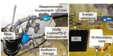
Bild 5. Fotos der Trübungsmessstelle nahe des Druckschachts (a) und der eingerichteten Datenakquisition (b) im Wasserschloss Kessiturm.
