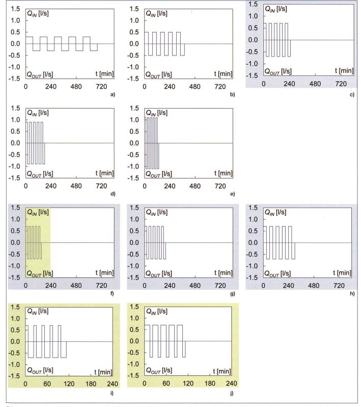
Bild 9. Auswahl von untersuchten In-Out-Sequenzen. Variation des Abflusses Q = 0.3 (a), 0.5 (b), 0.7 (c), 0.9 (d) und 1.1 l/s (e) für eine Zyklenfrequenz von  $Kt_P = 1.0$ . Variation der Zyklenfrequenz  $Kt_P = 0.6$  (f), 0.8 (g) und 1.2 (h) für einen Abfluss von Q = 0.7 l/s. Variation der relativen Zyklendauer  $t_{P,IN}/t_{POUT} = 0.5$  (i) und 2.0 (j) für Q = 0.7 l/s und  $Kt_P = 0.6$ .
