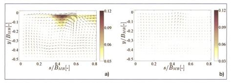
Bild 10. Horizontales Geschwindigkeitsfeld [m/s] auf Fassungshöhe  $z_i/B = 0.25$  während einer In- (a) und einer Out-Sequenz (b) für einen Abfluss von Q = 1.1 I/s und eine Zyklenfrequenz von  $Kt_P = 1.0$ .
