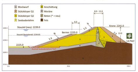
Bild 4. Aufbau des gezonten Schüttdamms.
