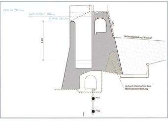
Bild 7. Typisches Querprofil durch die Südmauer mit Hochwasserentlastungsanlage.
