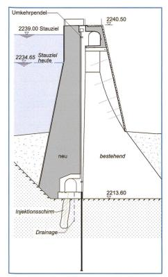
Bild 6. Typisches Querprofil durch die Südmauer.
