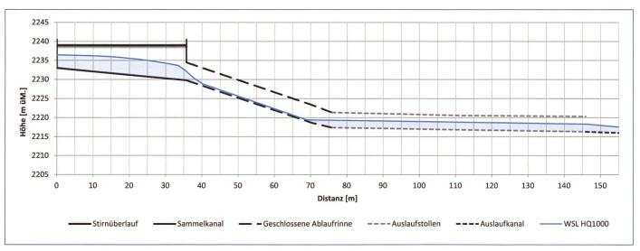
Bild 10. Schematische Darstellung des Ablaufsystems beim Bemessungshochwasser.
