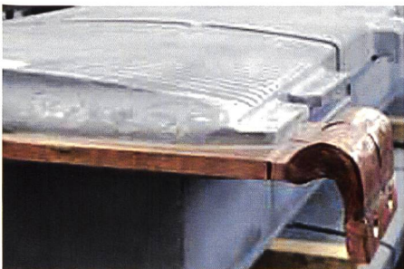
Bild 5. Erneuerung einer defekten Dämpferverbindung.
