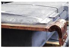
Bild 5. Erneuerung einer defekten Dämpferverbindung.
