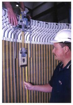
Bild 1: Nutverkeil-Kontrolle mit Robotor.
