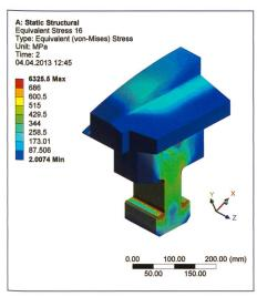
Bild 3. Berechnungsergebnisse einer FE-Berechnung.
