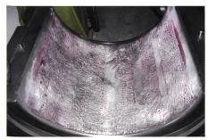
Bild 4. Reparatur des Weissmetalls einer Lagerschale: oft ist es nicht erforderlich, das komplette Lager neu auszugiessen.
