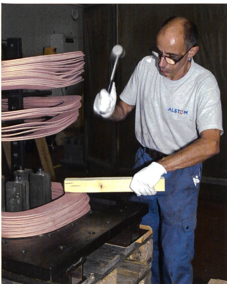
Bild 6. Neuinsolation einer Polwicklung.
