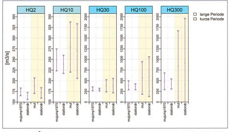
Bild 5.  $HQ_T[m^3/s]$  für Muota-Ingenbohl, berechnet mit einer nicht-stationären Modell-variante und der stationären Modellvariante des BLOCK-Ansatzes für das Jahr 2010, lange Periode (N: 88), kurze Periode (N: 37). Konfidenzintervalle gemäss Deltamethode,  $\alpha = 0.05$ .
