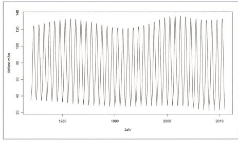
Bild 3.  $HQ_{30}$  [m<sup>3</sup>/s] für Muota-Ingenbohl, berechnet mit dem semi-parametrischen Verfahren (kurze Periode, df = 5).
