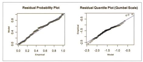
Bild 7. Diagnostikplots der Modellvariante «mujump» mit Wendepunkt 1970 des R5LARG-Ansatzes, Muota-Ingenbohl, lange Periode. Modellparameter:  $\mu$  vor 1970: 149.6835,  $\mu$  nach 1970: 167.0304,  $\sigma$ : 40.8593,  $\kappa$ : -0.0539.
