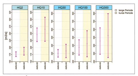
Bild 10.  $HQ_T[m^3/s]$  für Muota-Ingenbohl, berechnet mit der stationären Modellvariante des POT-Ansatzes, lange Periode (N: 171), kurze Periode (N: 120). Konfidenzintervalle gemäss Deltamethode,  $\alpha = 0.05$ .
