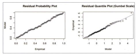
Bild 4. Diagnostikplots der Modellvariante «mujump» mit Wendepunkt 1970 des BLOCK-Ansatzes, Muota-Ingenbohl, lange Periode. Modellparameter:  $\mu$  vor 1970: 141.9257,  $\mu$  nach 1970: 162.1620,  $\sigma$ : 30.5639,  $\kappa$ : 0.1985.
