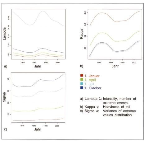
Bild 2. Parameterkurven des semi-parametrischen Verfahrens, angepasst an die Abflussdaten der Muota-Ingenbohl (lange Periode, df = 5).
