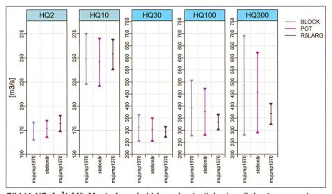
Bild 11.  $HQ_T[m^3/s]$  für Muota-Ingenbohl, berechnet mit den jeweils bestangepassten Modellvarianten des BLOCK-, POT- bzw. R5LARG-Ansatzes, lange Periode.
