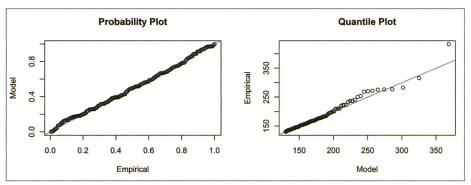
Bild 9. Diagnostikplots der Modellvariante «stat» des POT-Ansatzes, Muota-Ingenbohl, lange Periode. Modellparameter: σ: 31.18, κ: 0.14.
