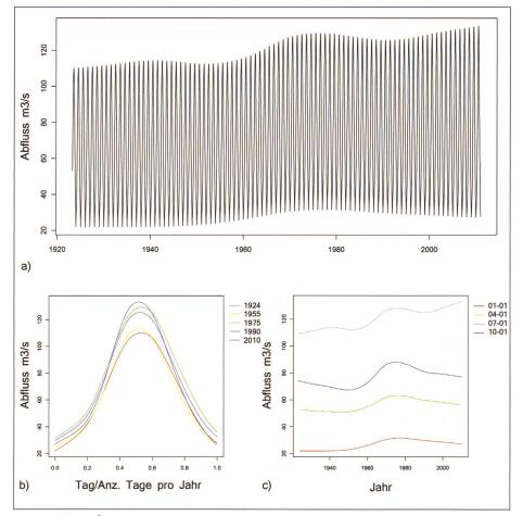
Bild 1.  $HQ_{30}$  [m<sup>3</sup>/s] für Muota-Ingenbohl, berechnet mit dem semi-parametrischen Verfahren (lange Periode, df = 5): a) Gesamtbetrachtung, b) in spezifischen Jahren, c) an spezifischen Tagen.
