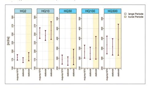
Bild 8.  $HQ_T[m^3/s]$  für Muota-Ingenbohl, berechnet mit einer nicht-stationären Modellvariante und der stationären Modellvariante des R5LARG-Ansatzes für das Jahr 2010, lange Periode (N: 435), kurze Periode (N: 185). Konfidenzintervalle gemäss Deltamethode,  $\alpha = 0.05$ .
