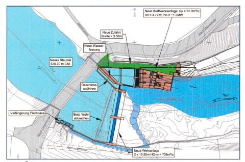
Bild 2. Übersicht über das neue Kraftwerk Mühlau an einer Innenkurve der Thur in Bazenheid (SG); Ausbauwassermenge 31 m<sup>3</sup>/s.
