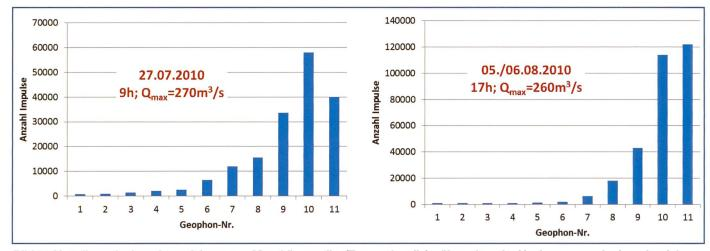
Bild 14. Verteilung der Impulse auf der ersten Messkörperreihe (Trennschwelle) während zweier Hochwasserereignisse des Jahres 2010 mit Angabe der Dauer des Geschiebetriebs ( $Q_{Thur} > 130 \text{ m}^3/\text{s}$ ) und des Spitzenabflusses.
