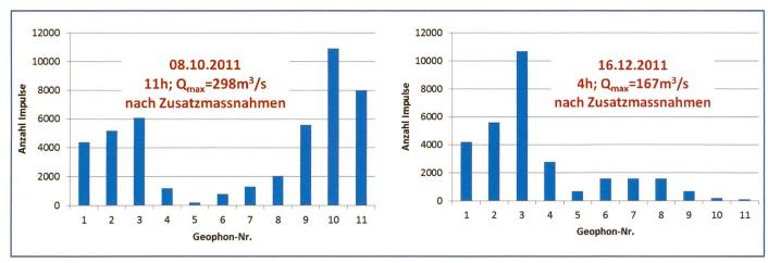
Bild 15. Verteilung der Impulse auf der ersten Messkörperreihe (Trennschwelle) nach Ausführung der Zusatzmassnahmen des Jahres 2011 mit Angabe der Dauer des Geschiebetriebs (Q<sub>Thur</sub> >130 m³/s) und des Spitzenabflusses.
