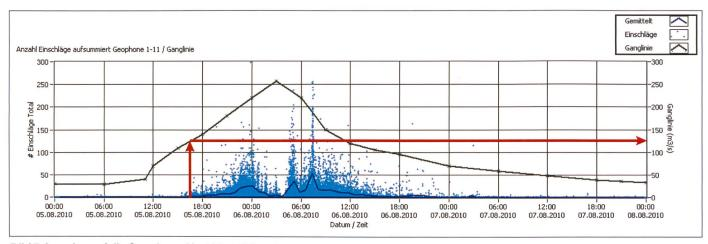
Bild 7. Impulse auf die Geophone Nr. 1 bis 11 hinterlegt mit dem Hydrograf (schematisch) des Pegels Thur-Jonschwil LH 2303 für das Ereignis vom 6. August 2010. Markiert ist der Beginn des Geschiebetriebs.
