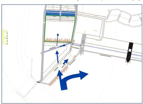
Bild 4. Anordnung der Geophone, nummeriert, vor und in der Wasserfassung des KW Mühlau; der erwartete Weg des Geschiebes ist als Arbeitshypothese schematisch eingezeichnet (blaue Pfeile).
