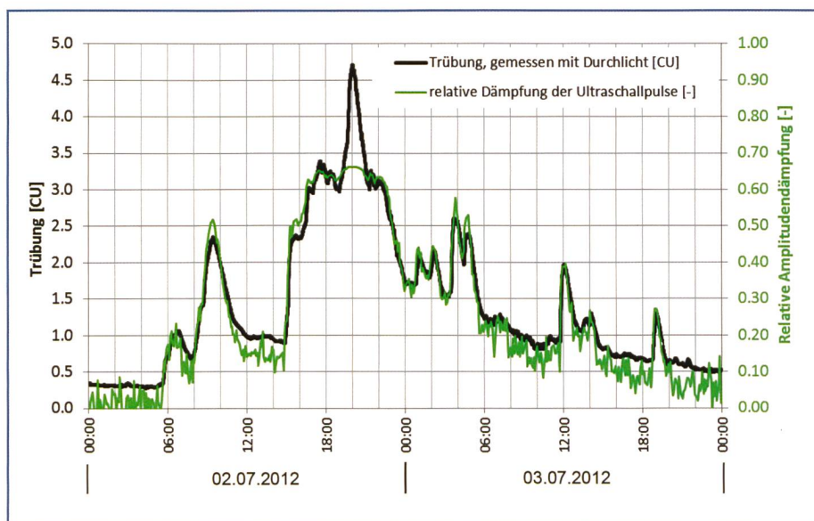
Bild 11. Verlauf der Trübung (linke Achse, Ausschnitt aus Bild 10) und der relativen Amplitudendämpfung von akustischen Ultraschallsignalen (rechte Achse) im Triebwasser des KW Fieschertal Anfang Juli 2012 (nach Felix et al. 2012b).
