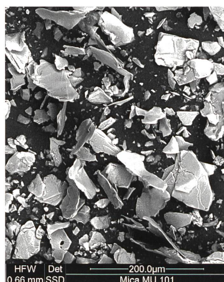
Bild 3. Mineralische Partikel, welche in den Laborversuchen betreffend Schwebstoffmessung verwendet wurden: Feldspatpulver (links, d_{50} = 34 \mu\text{m} ), Glimmerpulver (Mitte, " d_{50} " = 45 \mu\text{m} ) und Quarzfeinsand (rechts, d_{50} = 147 \mu\text{m} ) (Bilder: VAW und IfB, ETH Zürich).
