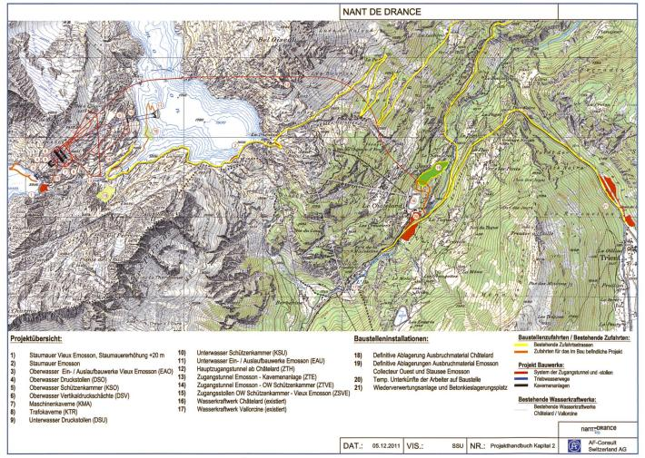
Bild 1. Pumpspeicherkraftwerk Nant de Drance, Übersicht der Untertagebauwerke.
