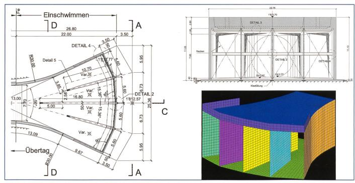
Bild 6.1. EAU im Grundriss (links oben). Bild 6.2. EAU Ansicht (rechts oben). Bild 6.3. Statisches System in 3D-Modell (rechts unten).
