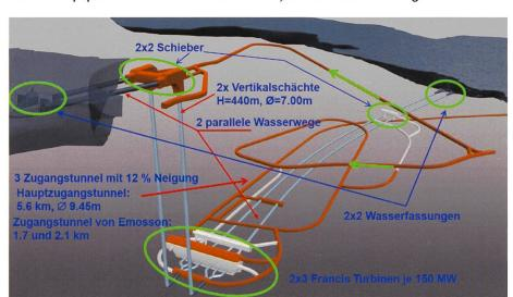
Bild 2. Triebwasserwege und Zugangsstollensystem.
