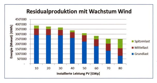
Bild 6. Aufteilung der Residuallast in Abhängigkeit der installierten PV-Leistung bei gleich starkem Ausbau der Windenergie.
