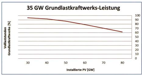
Bild 4. Anteil Stunden eines Jahres, während dem Strom von Grundlastkraftwerken mit einer Gesamtleistung von 35 GW benötigt wird, in Abhängigkeit von der installierten PV-Leistung.
