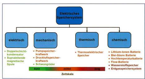
Bild 3. Klassifizierung von Energiespeichertechnologien. Quelle: [9].
