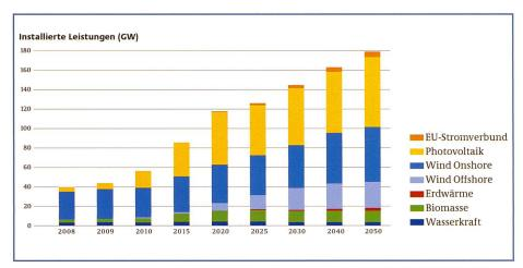
Bild 1. Ausbauszenario für erneuerbare Energien in Deutschland bis 2050 inklusive anteilige Leistung des Imports aus erneuerbaren Energien gemäss Szenario 2011 A. Quellen: Bild [4], Szenariodefinition und Datenquelle [12].
