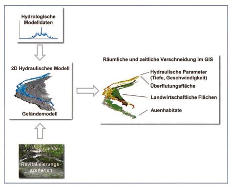
Bild 5. Schematische Darstellung der Modellierung mit anschliessender Datenanalyse im Geographischen Informationssystem (GIS).
