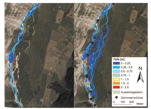
Bild 6.2. Erste Modellergebnisse für ein Hochwasser mit einer Wiederkehrdauer von einem Jahr (HQ<sub>1</sub>) ohne (links) und mit ausgewählten simulierten Aufwertungsmassnahmen (Gerinneanschluss durch Dammentfernung; rechts) zeigen deutlich positive Auswirkung auf die temporäre Anbindung von Gerinnen und auf die ökologisch bedeutsame Überflutung des Auenwaldes.
