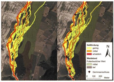
Bild 6.1. Erste Modellergebnisse der Gefährdung der Landwirtschaftsflächen durch Hochwasser mit einer Wiederkehrdauer von 30 Jahren (HQ<sub>30</sub>) ohne (links) und mit ausgewählten simulierten Aufwertungsmassnahmen (Gerinneanschluss durch Dammentfernung; rechts) zeigen nur geringfügige Unterschiede.
