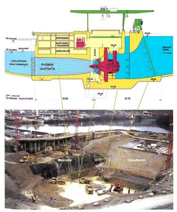
Bild 3. Schematische Lage des Maschinenhauses in der Baugrube.
