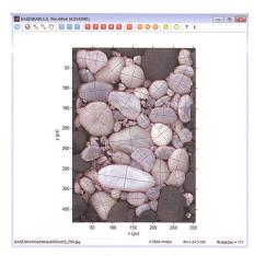
Bild 1. Exemplarische Ansicht mit detektierten Kieselementen.
