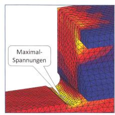
Bild 5. Modifizierte Geometrie eines Turboläufers.
