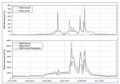
Figure 7. Comparaison entre mesures et simulations de l'année 2010. En haut, le bassin versant de Baokang (6400 km²). En bas, à l'embouchure dans le Yangtsé (170000 km²).
