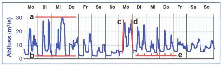
Bild 1. Schwallbeeinflusste Abflussgangline am Beispiel der Vispa bei Visp während zwei Wochen anfangs März 2012. Rot hervorgehoben sind die Parameter zur hydrologischen Beschreibung der Schwallereignisse: a: Maximalabfluss (Q<sub>max</sub>), b: Minimalabfluss (Q<sub>min</sub>), c: Schwallrate (QR<sub>Schwall</sub>), d: Sunkrate (QR<sub>Sunk</sub>), e: Häufigkeit der Schwallereignisse. Basierend auf hydrologischen Daten der Messstation des BAFU (BAFU Hydrologie 2012).
